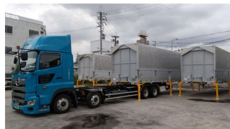
「SLOC」で使用するトラック。コンテナごとの交換でトラックの乗り換えや荷物の積み降ろしの負担を軽減する
