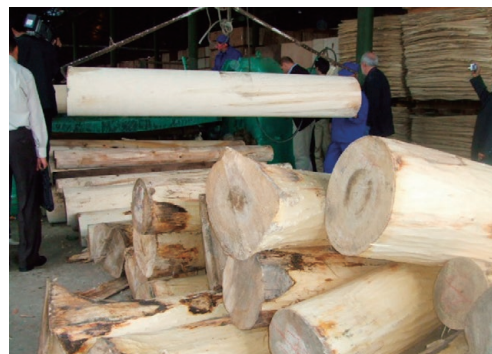
中国・徐州における単板製造の様子、5年生のポプラを使っている
